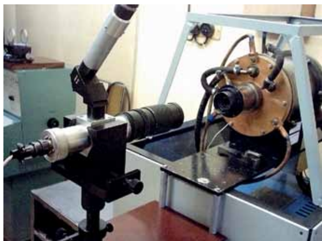
Рис.7. Настройка и поверка пирометра по модели АЧТ
