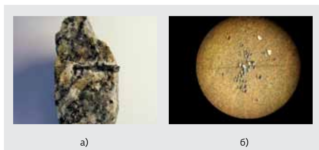
Рис.4. Негативные факторы высокотемпературного бурения: а) разрыв (во время остывания) образца гранита (толщина 25 мм) после формирования в нем сквозного отверстия; б) шарики затвердевшего расплава (диаметр до 1 мм), выносимые воздушной струей из отверстия при бурении бетона
