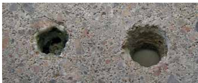
Рис.7. Входные отверстия, пробуренные высокотемпературным методом за счет испарения и плавления (слева) и лазерно-механическим методом с диаметром головки бура 10 мм (справа) (диаметр лазерного пятна на материале 6 мм)
