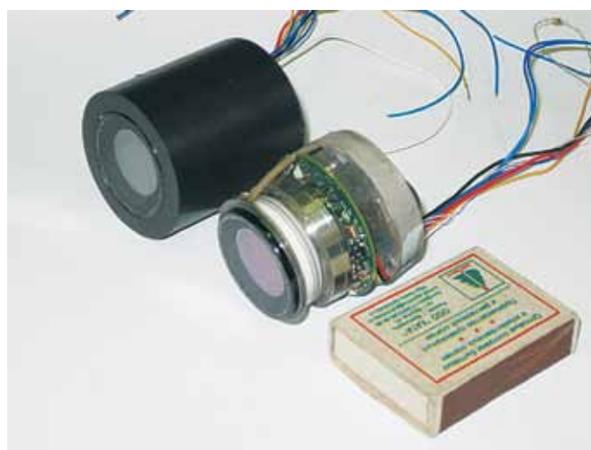
Рис.2. Вакуумный блок в сборе и вакуумный блок в металлокерамическом корпусе
