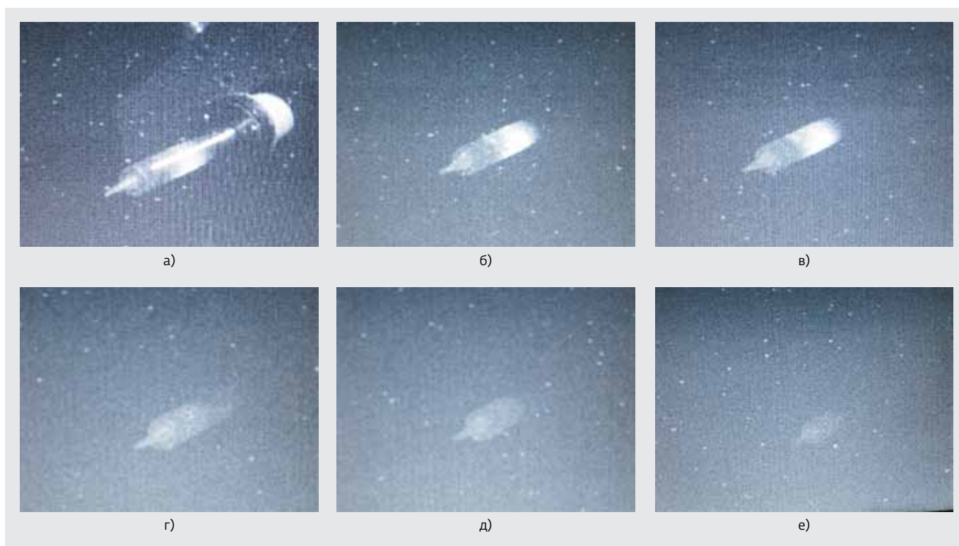
Рис.3. Зависимость чувствительности преобразователя от длины волны: а) – нагретый паяльника при освещенности 5 \cdot 10^{-4} лк; б) – е) нагретый паяльник при отсутствии освещенности (фото расположены в порядке, соответствующем остыванию жала паяльника)
