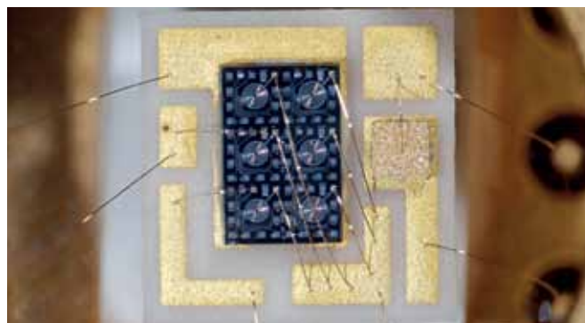
Рис.2. RE-SPAD-чип, установленный на керамической плате
