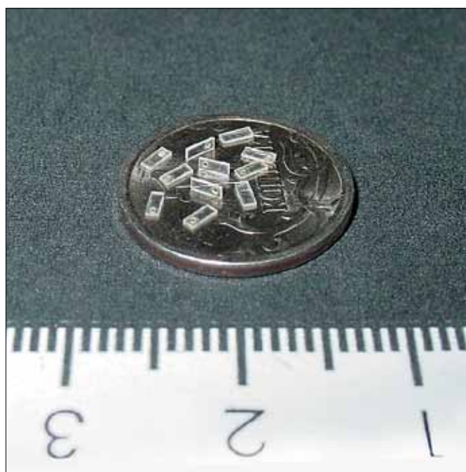
Рис.3. Образцы стекла PYREX, вырезанные методом Intrascibe
