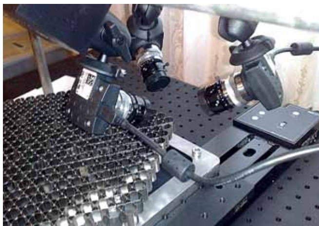
Рис.2. Взаимное расположение телекамер для сканирования
