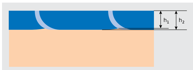
Рис.9. Схема наложения дорожек упрочнения при лазерной обработке многоканальным лазером
