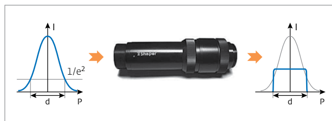
Рис.5. Устройство оптического выравнивания распределения плотности мощности в сечении луча
