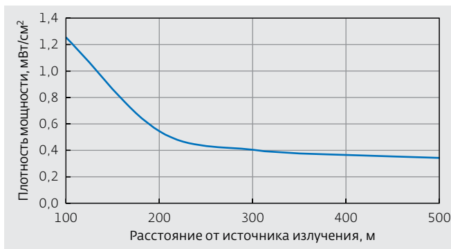
Рис.3. Зависимость средней плотности мощности излучения ЛИ-635-150 от расстояния до источника
