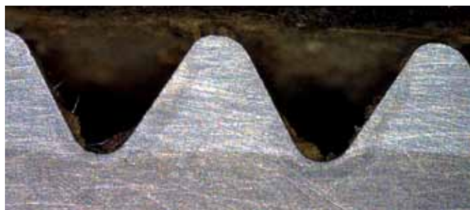
Микрошлиф резьбы с лазерным упрочнением
