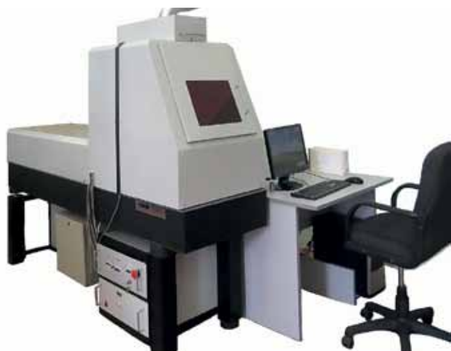
Рис.2. АЛТУ "Каравелла-2" с одноканальным ЛПМ со средней мощностью до 7 Вт
