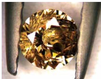
Рис.4. Бриллиант фантазийного ярко-желтого цвета, полученного путем имплантации ионов гелия с дозой 1,0 \cdot 10^{16} ион/см 2
