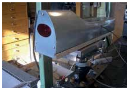
Рис.2. Лазерный доплеровский измеритель перемещений и деформаций – лазерный доплеровский катетометр (ЛДК)
