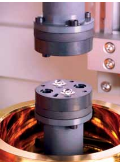
Рис.1. Две стеклянные заготовки на прессформах в технологической камере
