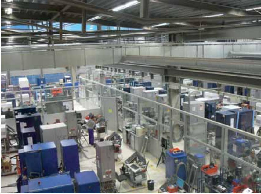
Фото 6. Цех сборки технологических CO 2 -лазеров, такт сборки 64 минуты
