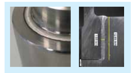
Рис.5. Пример сварки лазером SLAB-CO 2 (ROFIN DC 080) при скорости 1,5 м/мин: слева – поверхность шва, защищенная от окисления аргоном, справа – поперечное сечение
