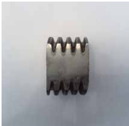
Рис.2. Микрошлиф ходового винта (сталь У8А), упрочненного сканирующим лазерным лучом
