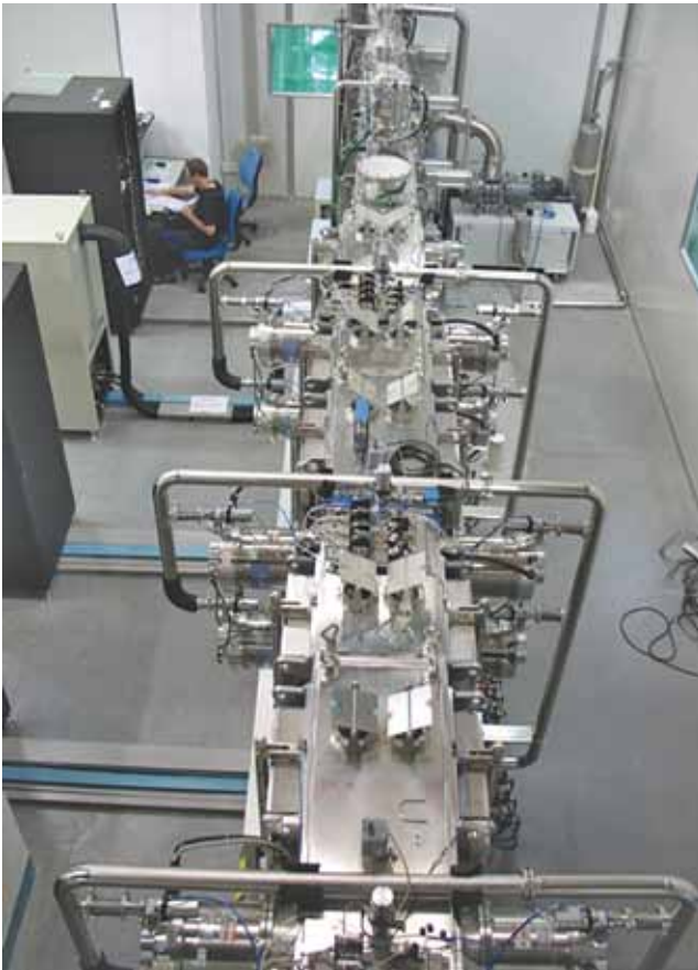
Линейная вакуумная установка проходного типа Izoline-1000
