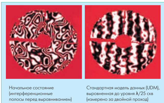
Рис.6 Выравнивание деформируемого зеркала компании Xinetics с использованием датчика волнового фронта WaveScope с его опцией адаптивной оптики
