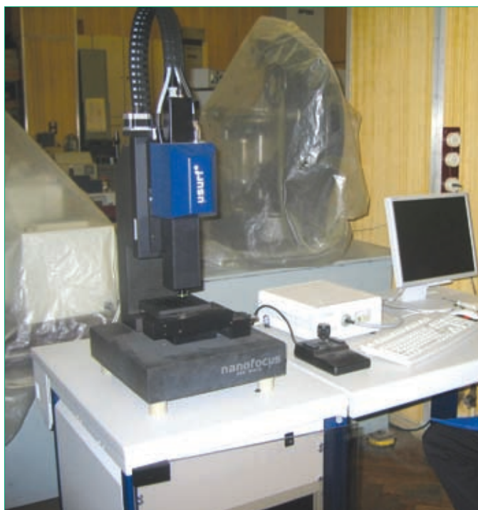
Рис.3 Микроскоп (Nanofocus) для контроля шероховатости и формы детали
