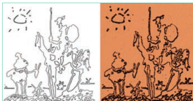
Рис.3 Нанолитография. Исходный графический файл и изображение, полученное на поверхности (Asylum Research)
