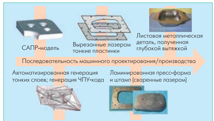
Рис.3 CAD-CAM последовательность этапов быстрого изготовления многослойных инструментов для формовки металлических листов
