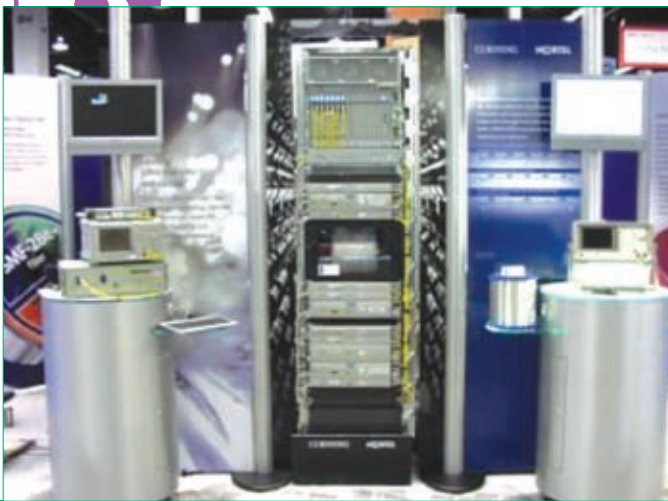
Рис.3 Установка Corning-Nortel, реализующая 800-км регенераторную секцию
