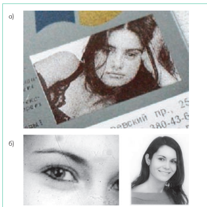
Рис.9 Изображения высокого разрешения, выполненные на нержавеющей стали (а) – система "МиниМаркер-М10" (ОВ-лазер) и на ABS-пластике (б) – система "ДиоМаркер-Д10" (Nd:YAG-лазер с диодной накачкой)
