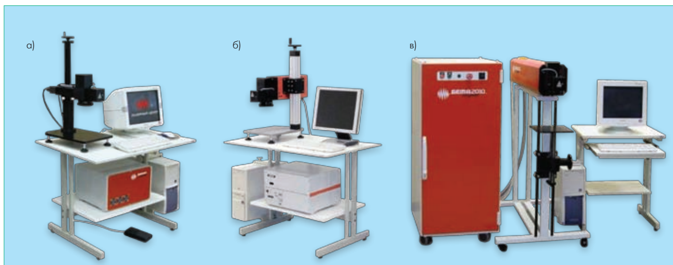
Рис.3 Вид установок лазерной маркировки и гравировки: а) "МиниМаркер-М10" на базе ОВ Yt-лазера; б) "ДиоМаркер-Д10" на базе Nd:YAG-лазера с диодной накачкой; в) "БетаМаркер-2010" на базе традиционного Nd:YAG-лазера с ламповой накачкой
