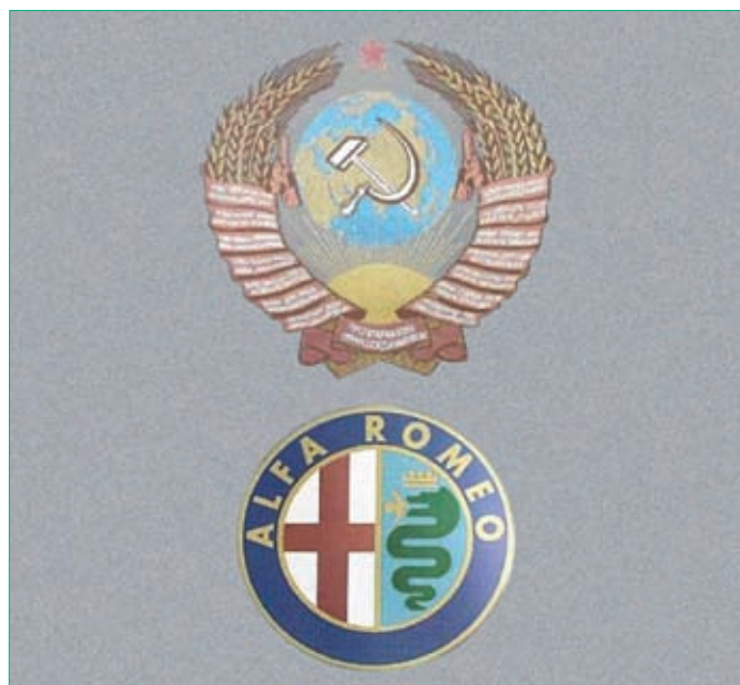
Рис.10 Цветные изображения при маркировке системой "МиниМаркер-М10" с ОВ-лазером (полированная нержавеющая сталь)
