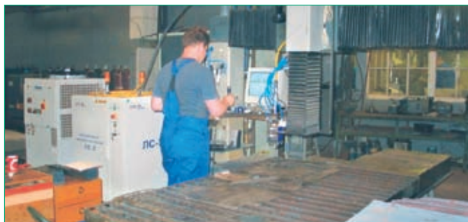
Рис.2 Замена генератора иттербиевым волоконным лазером ЛС-2
