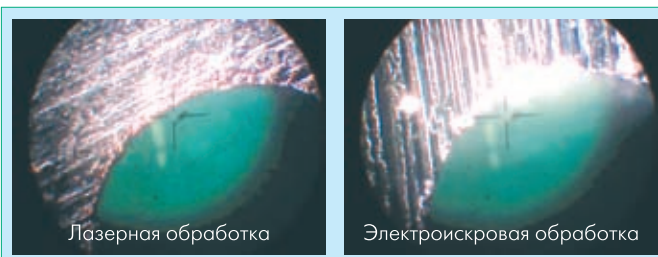
Рис.1 Фрагменты диафрагмы из Мо ( t = 0,16 мм, увеличение \times 500 )
