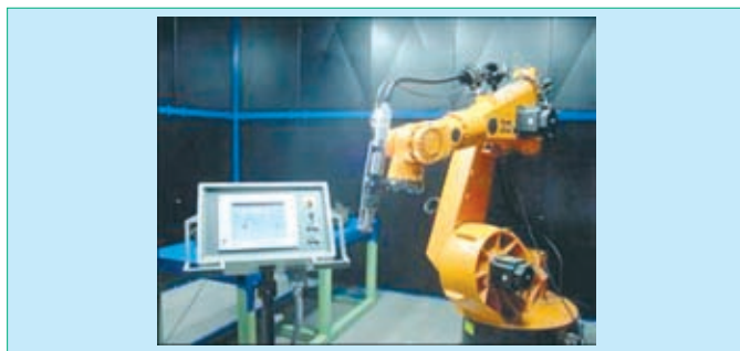
Рис.3 Лазер-робот с оптоволоконным лазером для резки, сварки и наплавки объемных конструкций
