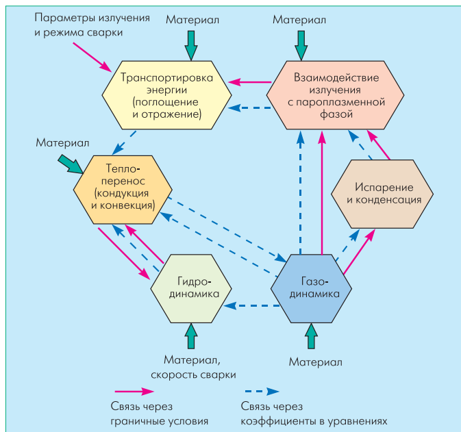
Рис.1 Структура задачи о лазерной сварке металлов
