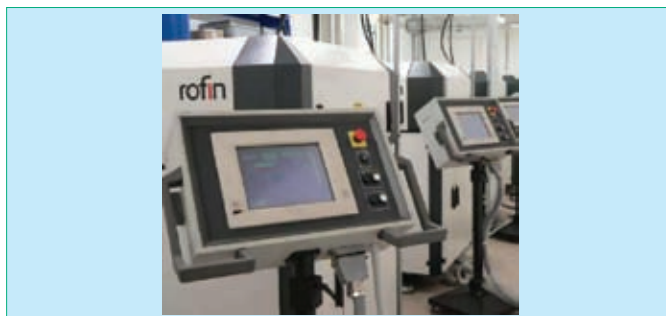
Рис.4 Помещение производства DEKA-VII, в котором работают твердотельные лазеры компании ROFIN с диодной накачкой
