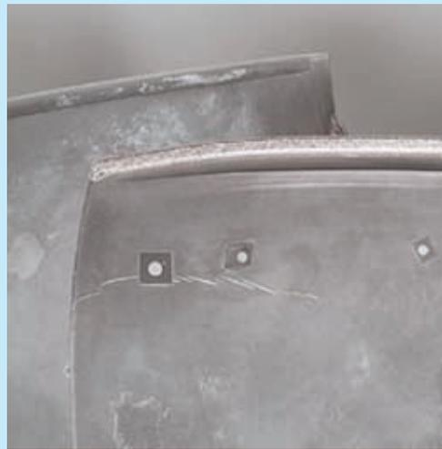
Рис.2 Отремонтированный край лопатки компрессора
