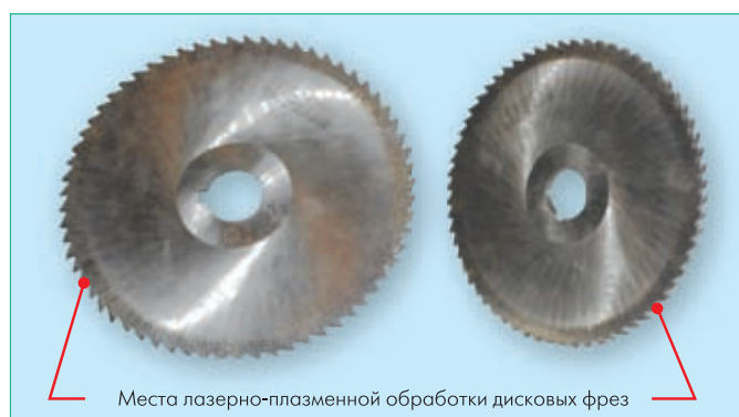
Рис.1 Дисковые отрезные фрезы, обработанные лазерно-плазменным методом
