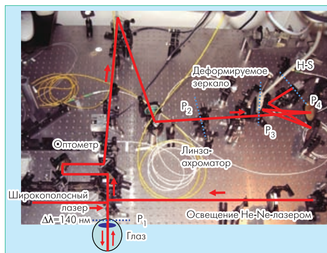
Рис. 1 Схема системы АО для глаза. Оптически сопряженные плоскости указаны штриховыми линиями
