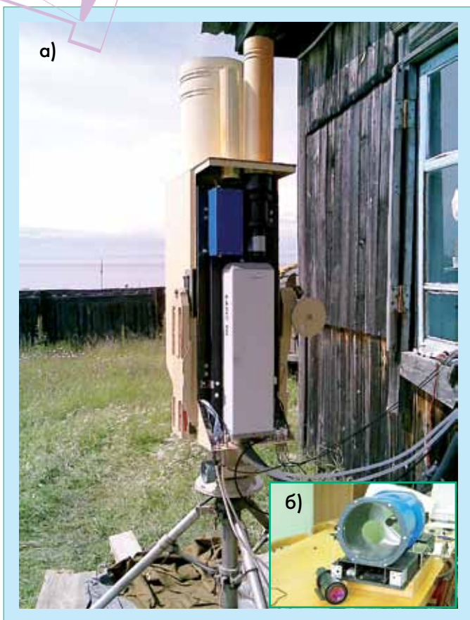
Рис. 2 Лидар ЛОЗА-М2: а) полевые испытания на стационаре Бурятского научного центра СО РАН, п.Боярск; б) внешний вид приемных телескопов ближней и дальней зон лидара
