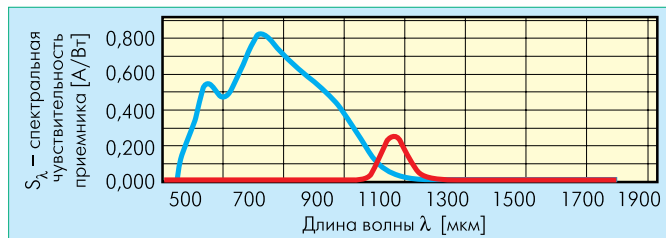
Рис. 2 Спектральные характеристики приемника в пирометрах ДИЭЛТЕСТ: синяя кривая – коротковолновая область, красная – длинноволновая
