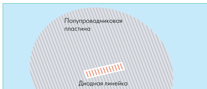
Рис.1 Компоненты полупроводникового элемента из GaAs
