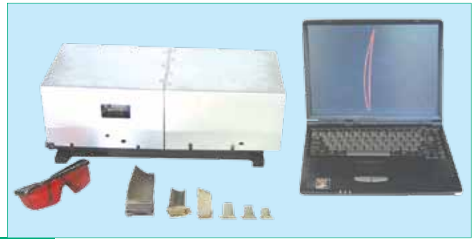
Рис.6 Внешний вид прибора ПКПЛ рядом с лопатками авиадвигателя
