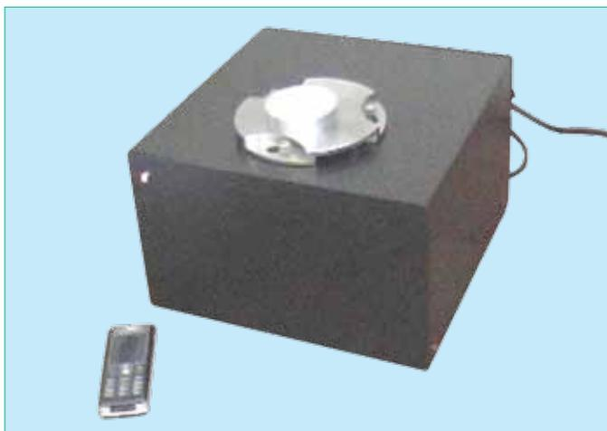
Рис.3 Анализатор состава сталей АСЧ-01
