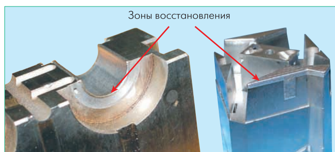
Рис.1 Изделия, восстановленные с помощью лазерной наплавки
