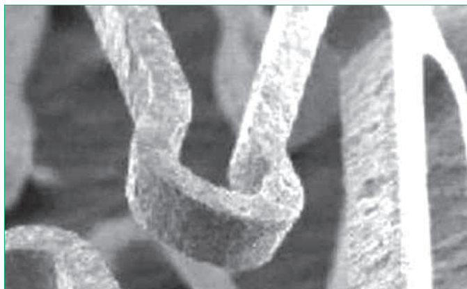
Рис.2 Элементы стента, полученного прецизионной резкой тонкостенного нитинола лазером серии KLS246
