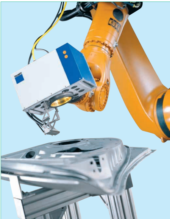
Рис. 5 Оптический узел PFO для точного позиционирования лазерного луча
