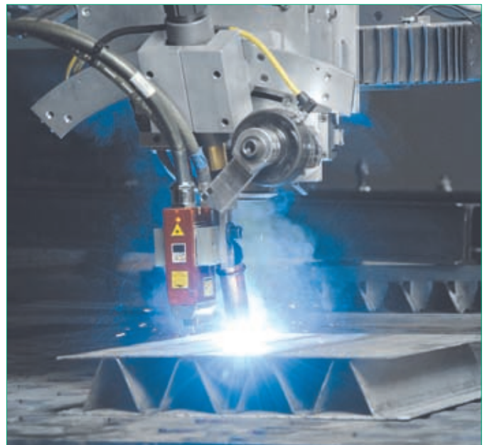
Рис. 3 Использование технологии гибридной лазерной сварки при изготовлении многослойных панелей
