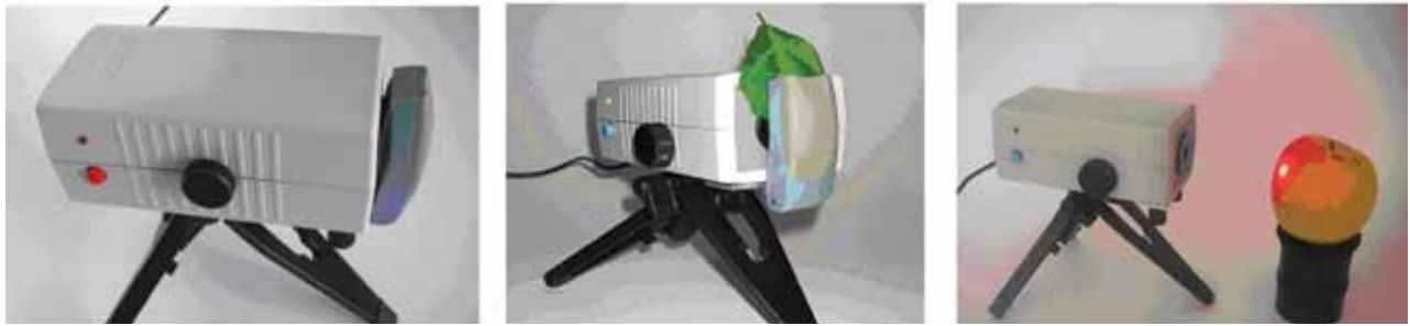
Рис.9. Универсальный диагностический прибор, способный работать как в режиме пропускания, так и в режиме отражения света ЛАТ-3К
