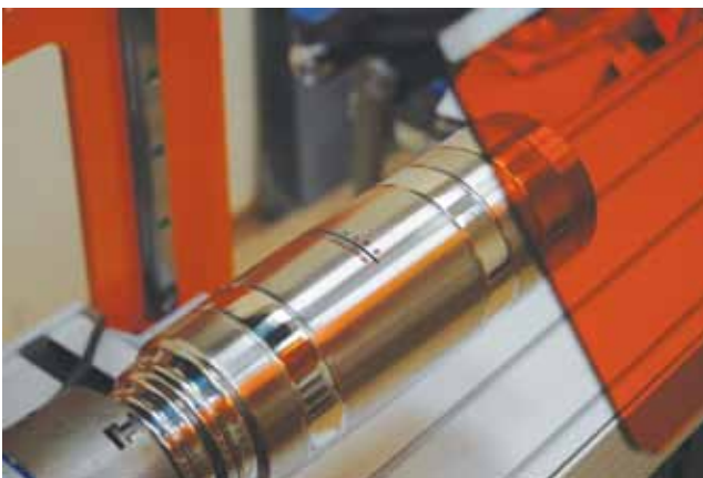
Рис.1. Нанесение изображения на деталь вращения
