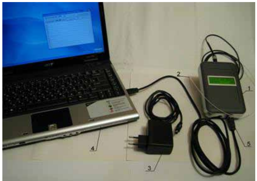
Рис.3 Подключенный к компьютеру термодозиметр и комплектующие: 1 – термодозиметр; 2 – чувствительный элемент термодатчика; 3 – сетевой адаптер; 4 – ПК; 5 – USB-кабель сопряжения с ПК
