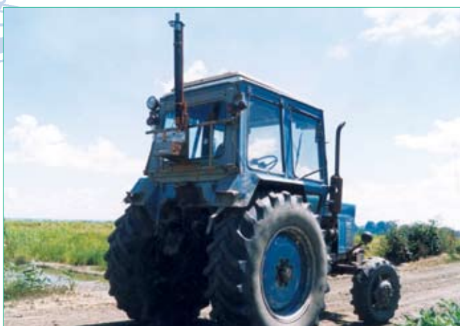
Рис.2 Лазерная установка для обработки посевов в поле, навешенная на трактор
