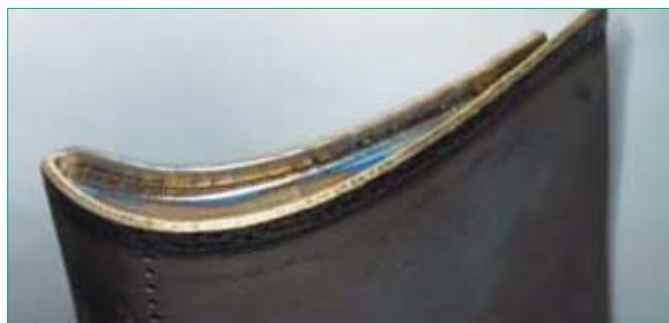
Рис.7 Лопатка авиационной турбины, восстановленная лазерной порошковой наплавкой
