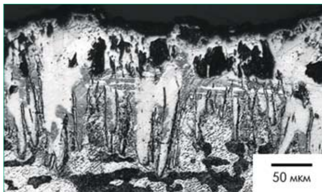
Рис.2 Микрошлиф борированного слоя после химико-термической обработки
