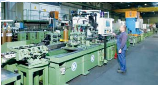
Рис.3 Установка для лазерной сварки труб из нержавеющей стали
