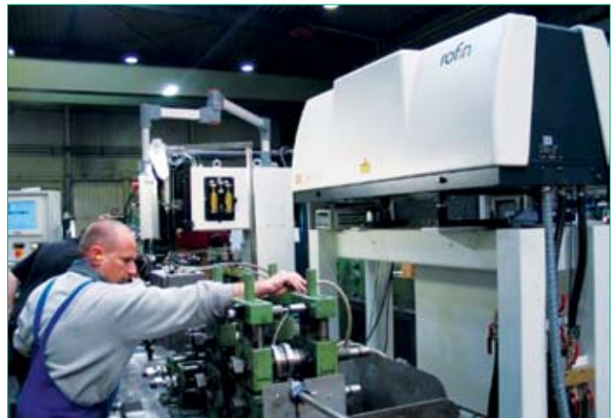
Рис.2 Плоский CO 2 -лазер ROFIN DC 045 мощностью 4,5 кВт
