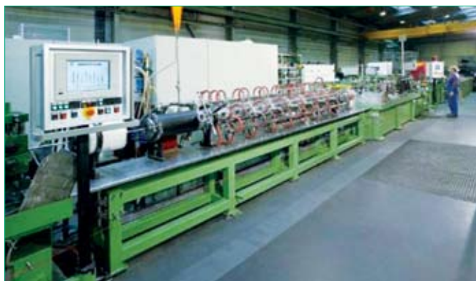
Рис.1 Печь для отжига, интегрированная в линию лазерной сварки труб на фирме Esta Rohr
