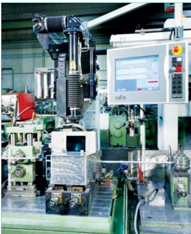
Рис.4 Система PWS с дисплеем для контроля параметров работы лазера и мониторинга процесса выполнения сварного шва
