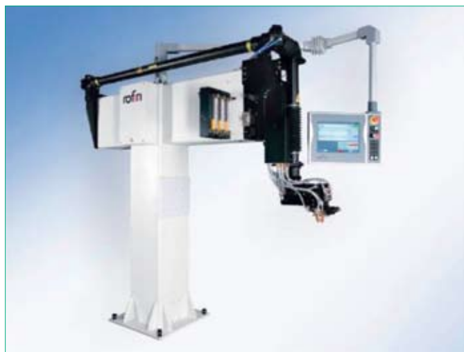
Рис.7 Система Profile Welding System (PWS) компании ROFIN для управления сваркой труб и профилей
