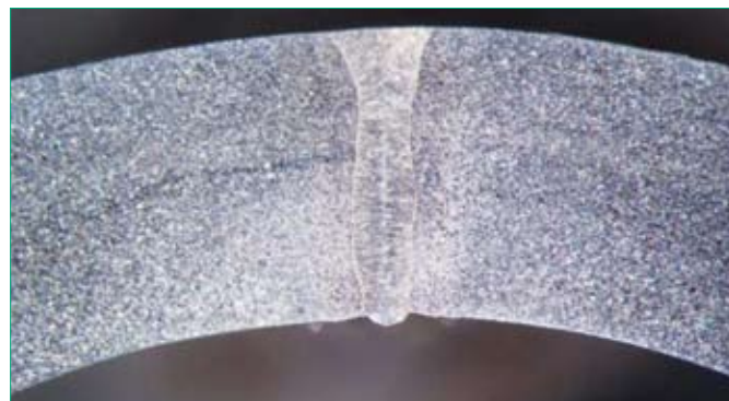
Рис.6 Поперечный разрез трубы, сваренной с использованием лазерной технологии (22,5×2,6 мм, сталь 1, 4301, без отжига)
