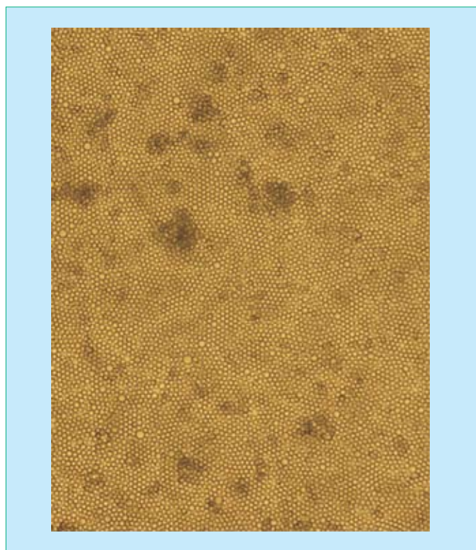
Рис.4 Расположение микросфер d=6 мкм на поверхности жидкости при V_{\text{суспензии}} = 70 мкл
