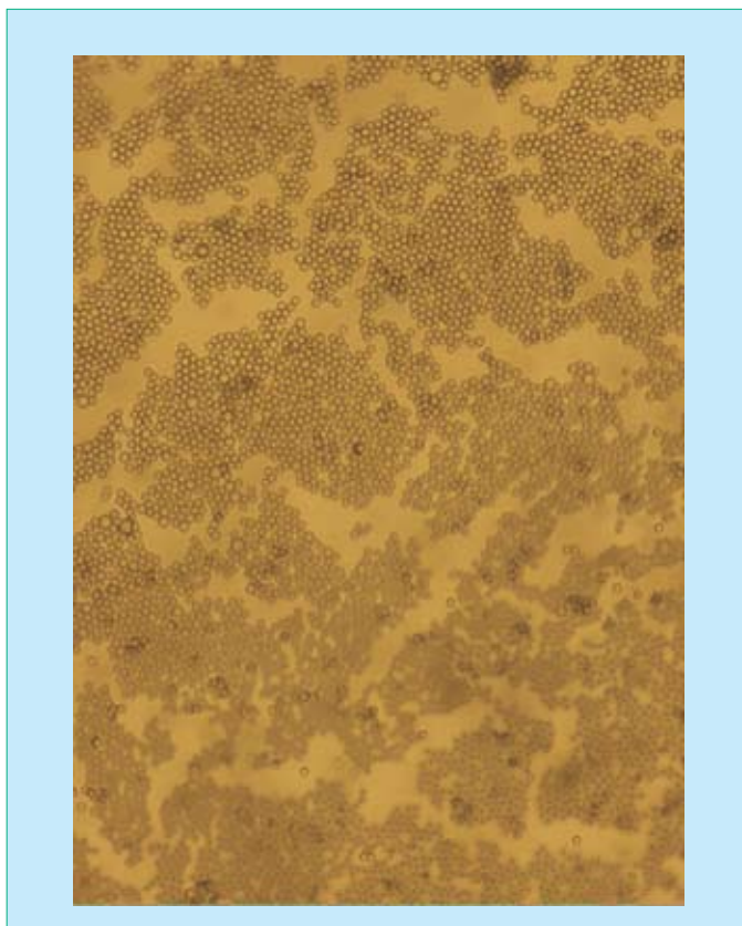
Рис.3 Расположение микросфер d=6 мкм на поверхности жидкости при V_{\text{суспензии}} = 50 мкл
