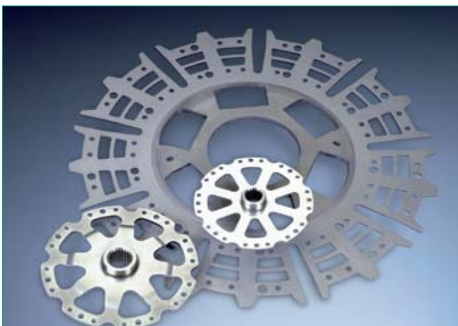
Рис.2 Детали, обработанные CO 2 -лазером TruCoax фирмы TrumPF
