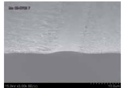
Рис.6. Результат скрайбирования молибдена фемтосекундными импульсами FL1000
