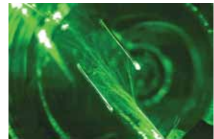
Рис.5. Треки между полосками-электродами не реагируют на напряжение между ними в 30 кВ (расстояние между электродами 10 мм)
