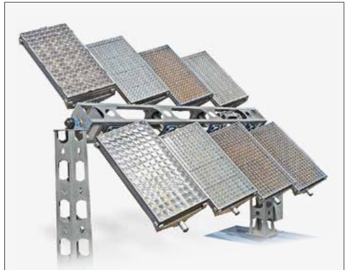
Рис. 1. Прототип СЭС с восемью ПСМ с установленной мощностью 1–2 КВт. Концентрирование солнечного излучения обеспечивается панелью линз Френеля, двухосевое слежение за Солнцем обеспечивается следящей опорой [7, 8]
